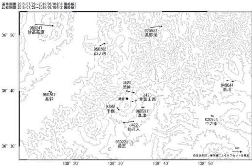
第3図 草津白根山周辺の国土地理院・気象庁・防災科学技術研究所 GNSS 観測点の統合解析による水平変動ベクトル図 (上段:2016年4月~2016年7月、下段:2015年7月~2016年7月)
