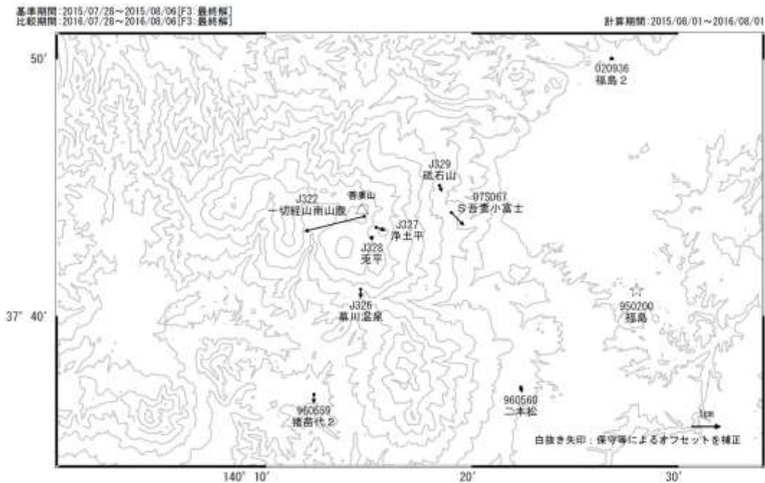
第3図 吾妻山周辺の電子基準点・気象庁GNSS観測点統合解析による水平変動ベクトル図(上段:2016年4月~2016年7月、下段:2015年7月~2016年7月)
