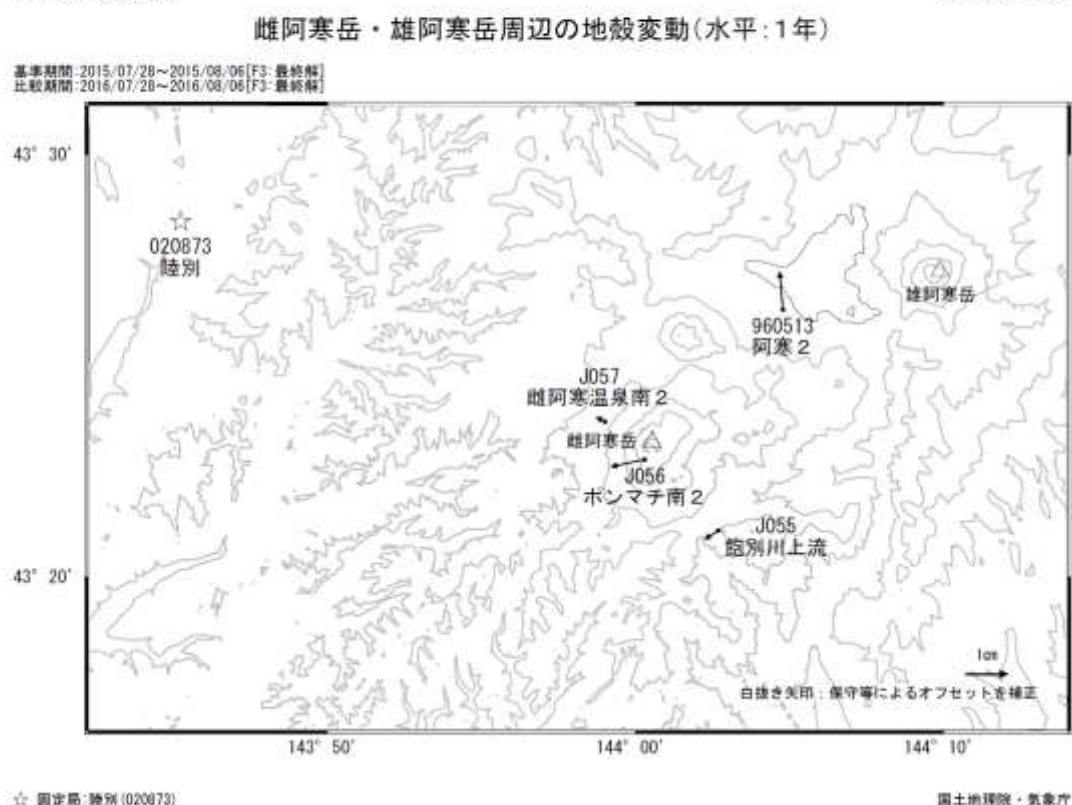
第2図 雌阿寒岳周辺の電子基準点・気象庁 GNSS 観測点の統合解析による水平変動ベクトル図(上段:2016年1月~2016年7月、下段:2015年7月~2016年7月)
