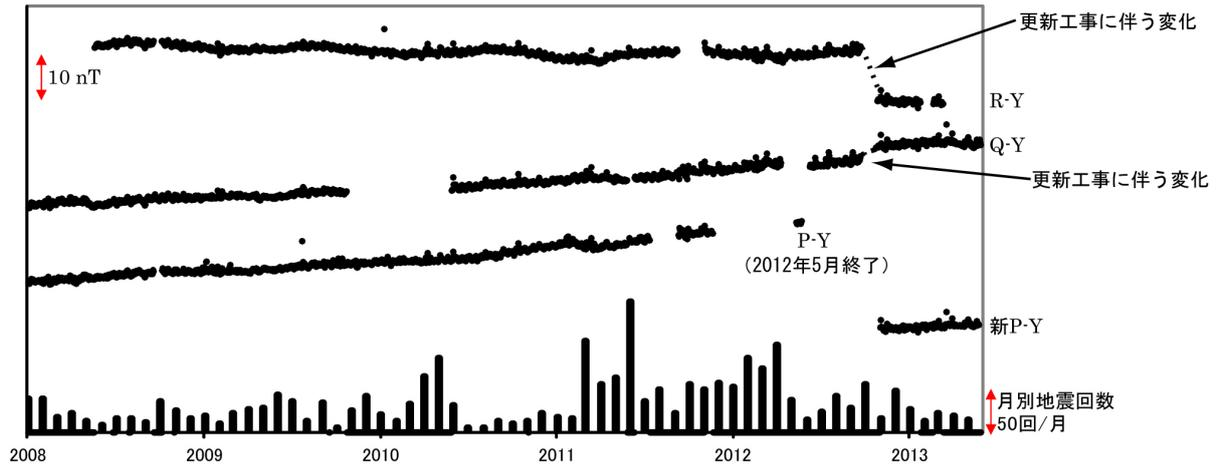
第2図 全磁力連続観測による全磁力値の変化及び月別地震回数（2008年1月～2013年5月）。連続観測点P、Q、Rおよび新Pにおける八ヶ岳地球電磁気観測所（東京大学地震研究所）との全磁力の日平均値差。最下段に草津白根山で観測された月別地震回数を示す。
