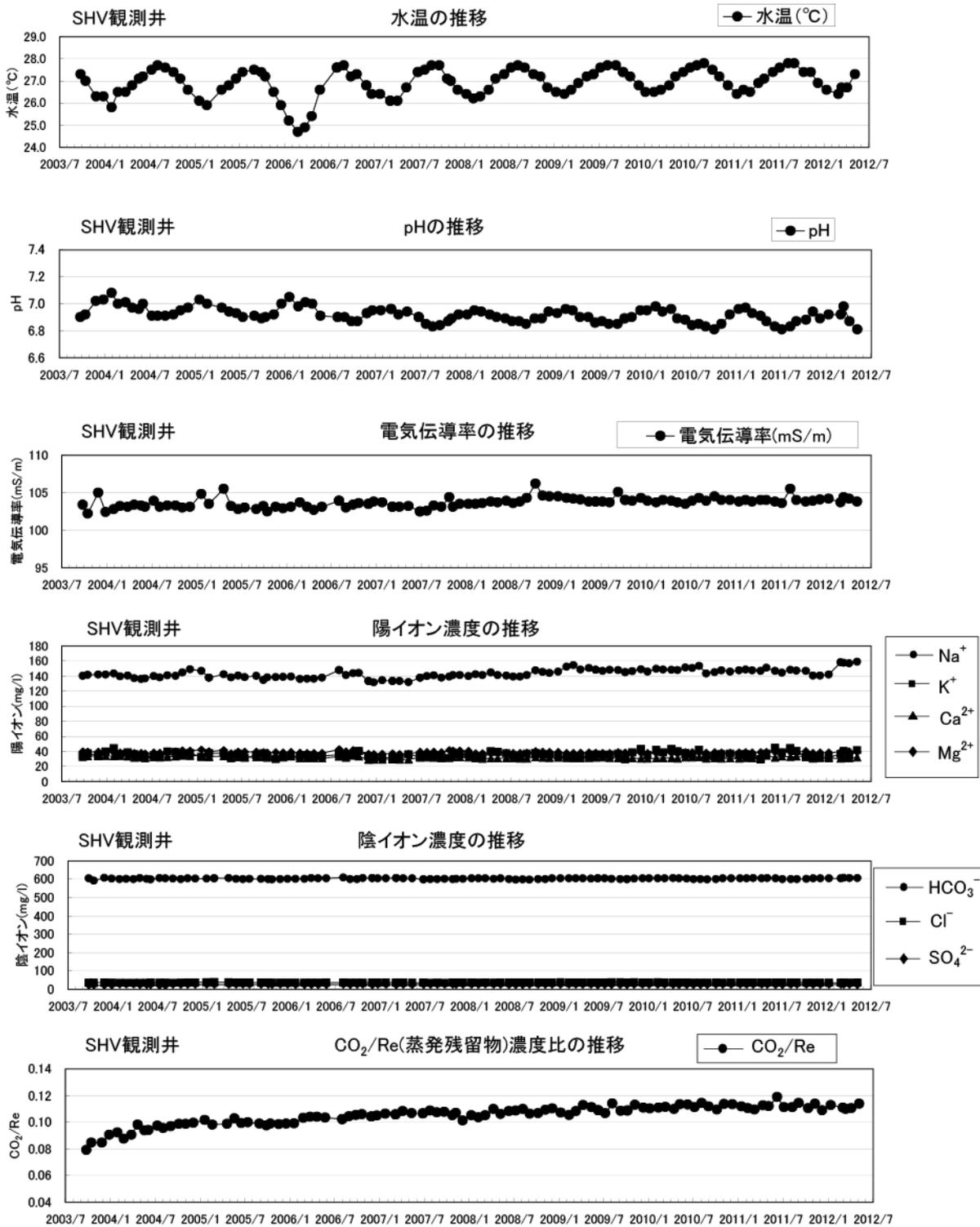
第2図 SHV観測井の水温・pH・電気伝導率・主要化学成分濃度・CO<sub>2</sub>/Re(蒸発残留物)濃度比の推移。
