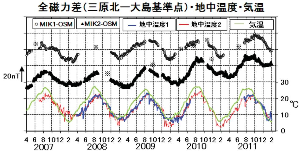
第2図 2007年4月から2012年1月までの連続観測点における全磁力日平均値と参照点OSMの日平均値との差 (○: MIK1-OSM, ▲: MIK2-OSM)、観測点近傍の地中温度および気温 (※は観測装置の障害による欠測期間、気温は大島特別地域気象観測所の気温データの30日移動平均値)
