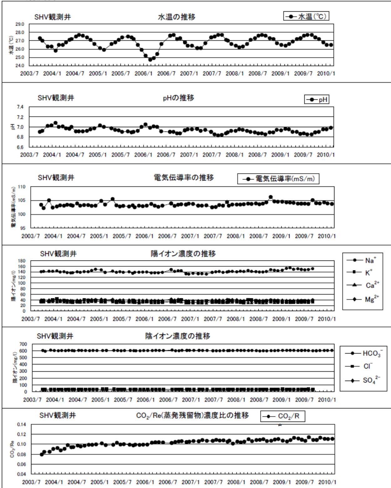
第4図 SHV観測井の水温・pH・電気伝導率・主要化学成分濃度・CO<sub>2</sub>/Re(蒸発残留物)濃度比の推移
