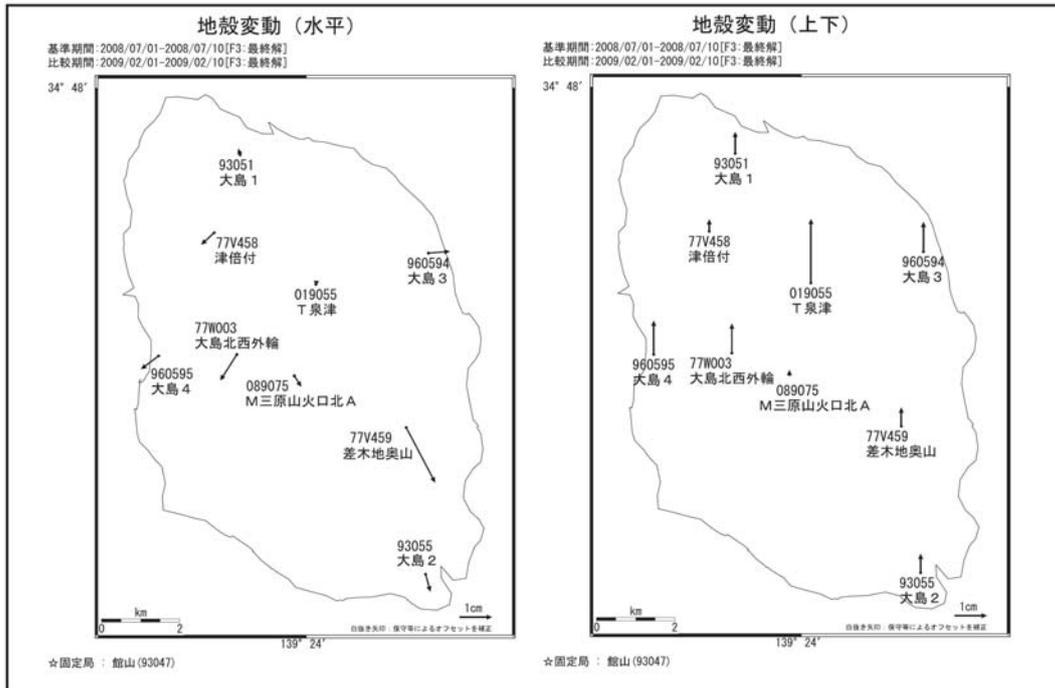
第2図 (a) 伊豆大島におけるGPS連続観測点の水平変動ベクトル図(左)および上下変動ベクトル図(右) (2008年7月～2009年2月)
