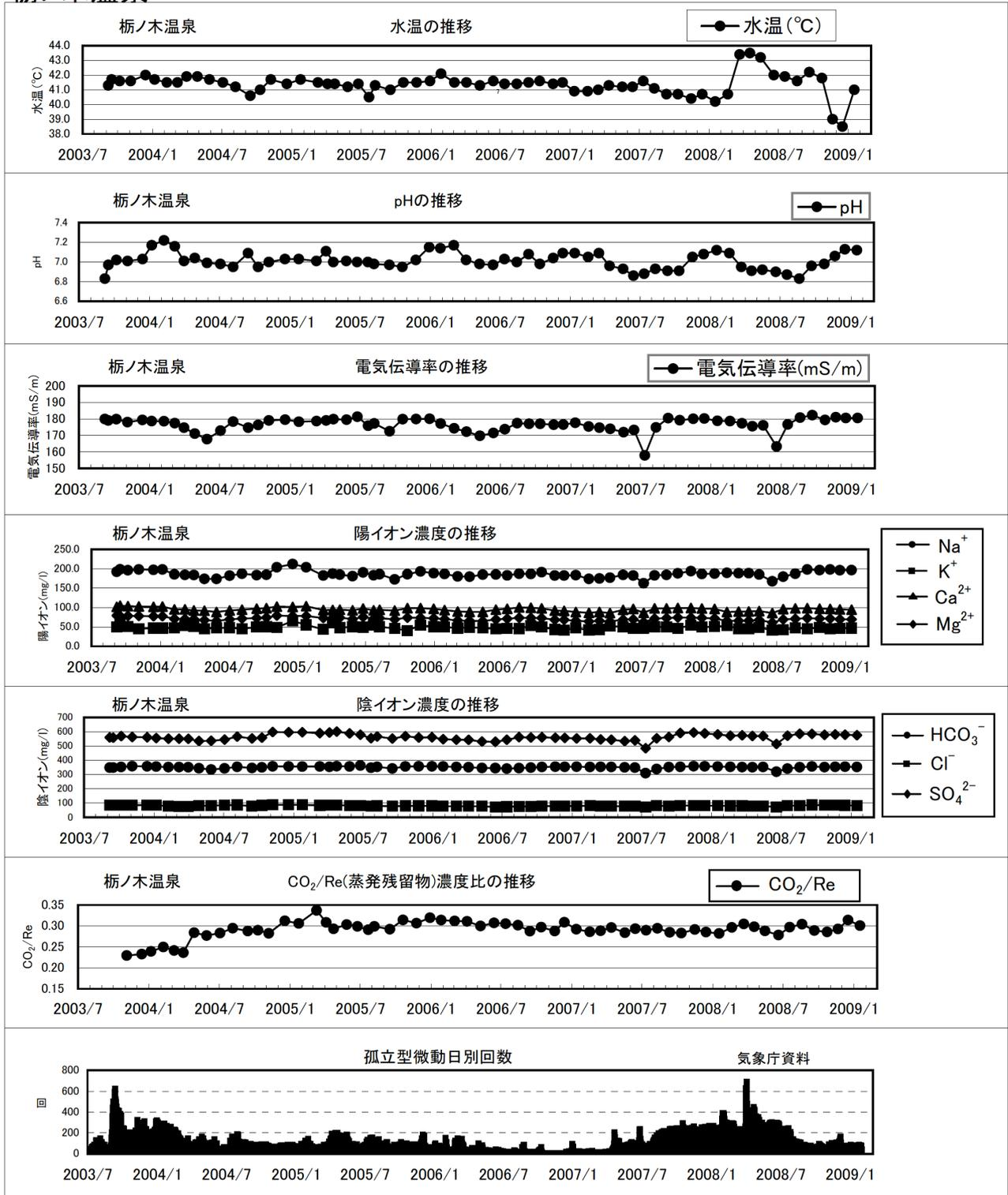
第1図 栃ノ木温泉小山旅館（平湯）の水温・pH・電気伝導率・主要化学成分濃度・CO<sub>2</sub>/Re(蒸発残留物)濃度比の推移。孤立型微動日別回数は気象庁資料。
