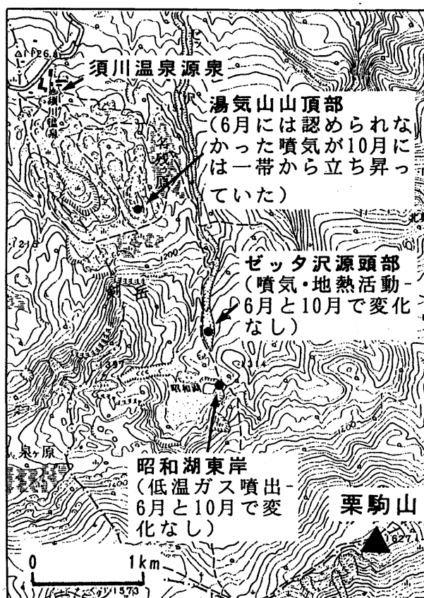
第3図 Fig. 3 1994年6月と10月に観測された栗駒山北斜面の噴気・地熱活動 Geothermal activities observed in June and October, 1994, on the northern flank of Kurikoma Volcano.
