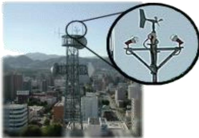
ランプによる風向風速計の凍結防止対策
