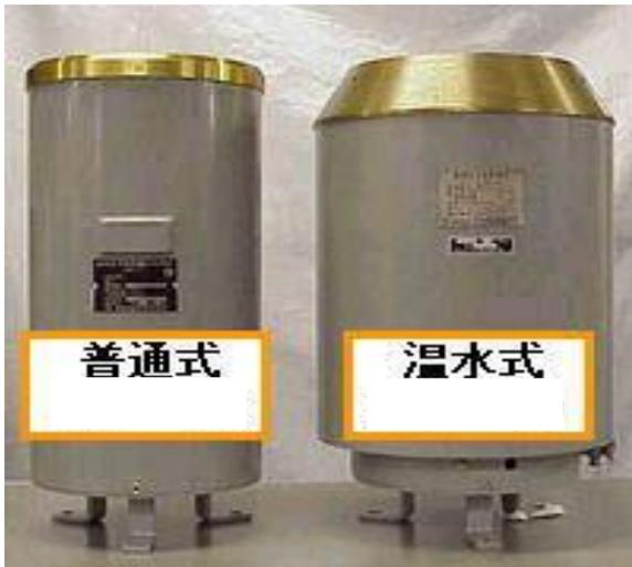
普通の雨量計と温水式雨量計の外観
