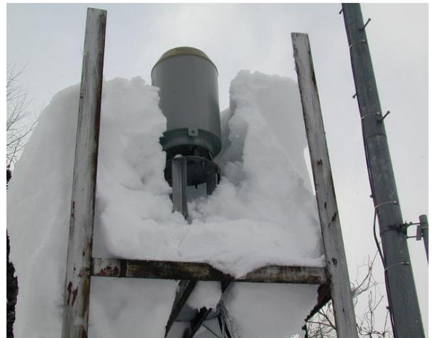
写真3 雨量計が凍結した例
