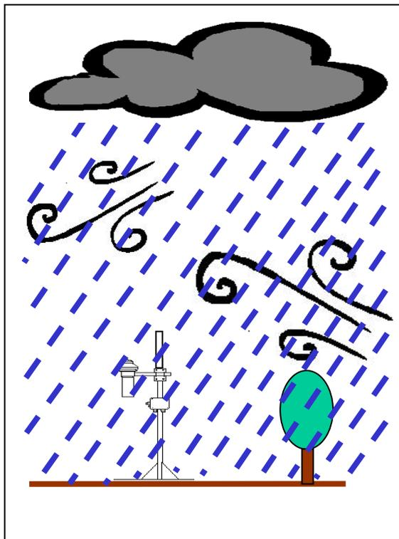
強い風雨により通風筒の内部に水が入ることがあります。この浸水により気温・湿度の測定に障害が発生することがあるため、強い風雨が発生した場合はデータに注意し、データが異常を示したときには作業者の安全に配慮のうえ点検を実施します。
