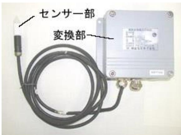
電気式湿度計はセンサー部と変換部からなっています。センサー部は後述する通風筒に設置され変換部とケーブルを介して電氣的に接続されます。変換部は湿度センサの静電容量を測定し、相対湿度に変換して出力します。
