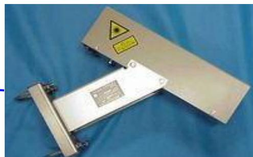
光電式積雪計とその送受波器
