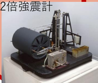
ミルン簡単 地震計(復元) 始動用感震器
