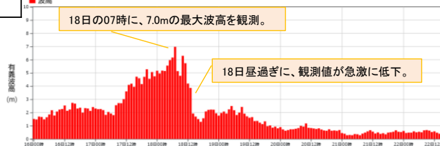
図5.2.6 志布志(上図)及び屋久島(下図)の有義波高観測値 出典:ナウファス(国土交通省港湾局 全国港湾海洋波浪情報網)
