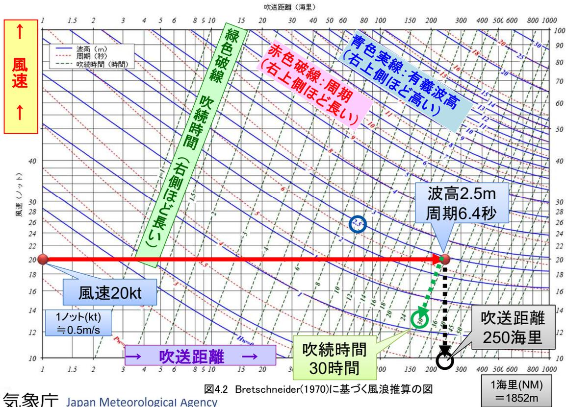
図4.2 Bretschneider(1970)に基づく風浪推算の図
