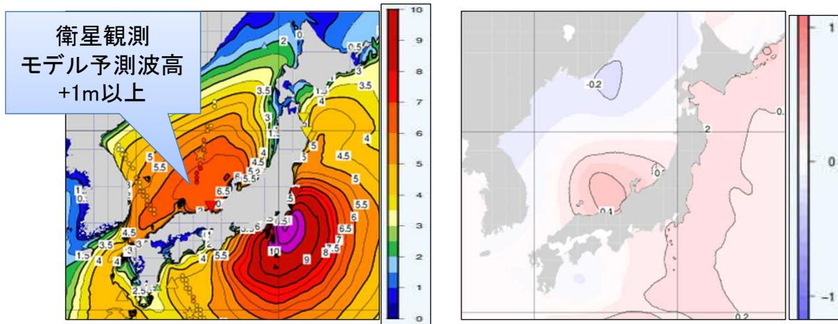
図付1.6 2019年10月12日12UTC初期値のモデル波高第一推定値(左)とデータ同化による修正量(右)(左図の○は衛星観測データ、▽は沿岸波浪計データ、☆はブイデータ)
