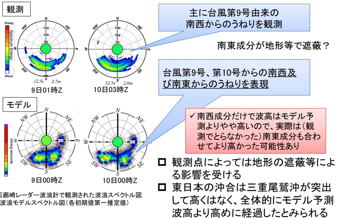
図付2.12 石廊崎レーダー波浪計で観測された波浪スペクトル図(上)と波浪モデルスペクトル図(各初期値第一推定値)
