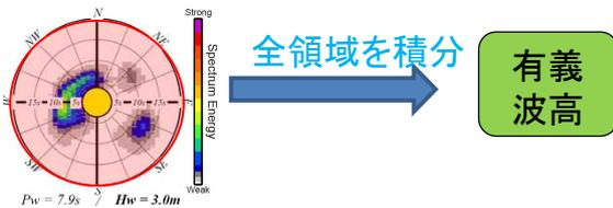
図2.8 二次元スペクトルから有義波高を算出する方法
