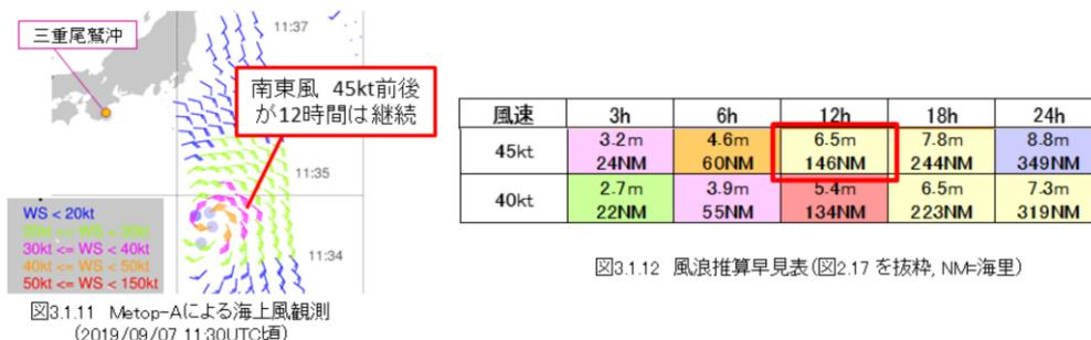
図3.1.12 風浪推算早見表(図2.17を抜粋, NM=海里)
