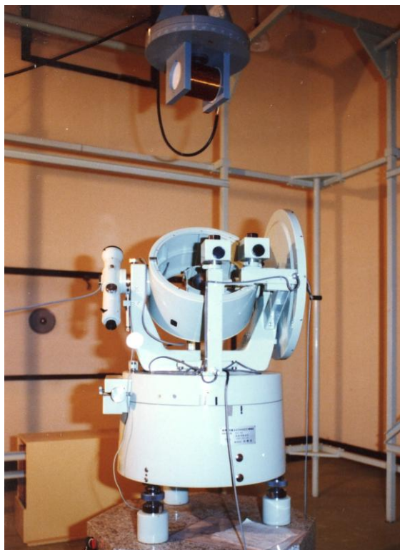
図 7-4-23 M0-PK型プロトン磁力計（F成分）（写真上）と DI-72角度測定器（D、I成分）（写真下）（1972年～）
