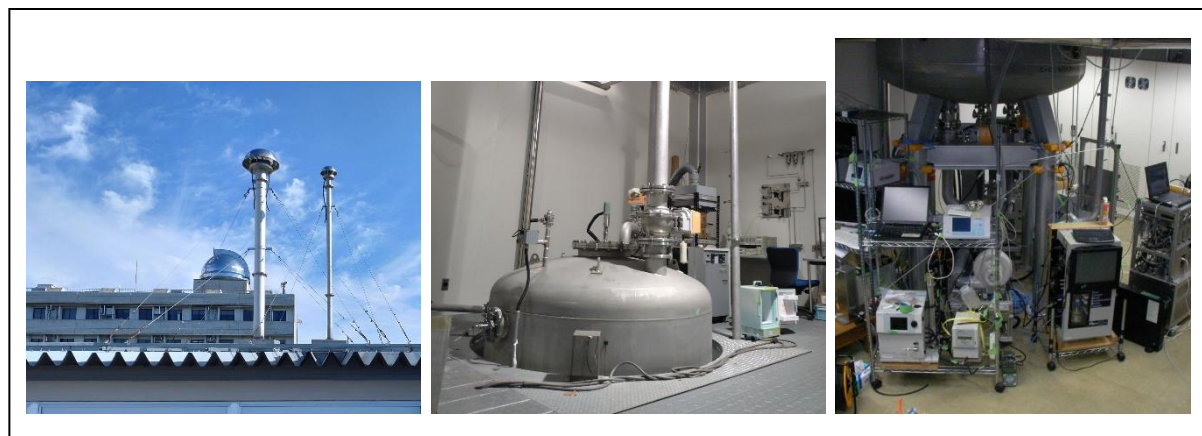
図 7-2-7 低温実験施設別棟内にあるエアロゾル地上モニタリング観測システムの様子 ・PM10インレット（屋上）（左） ・エアロゾルバッファータンク（1・2階）（中央） ・各種エアロゾル測定機器（右）
