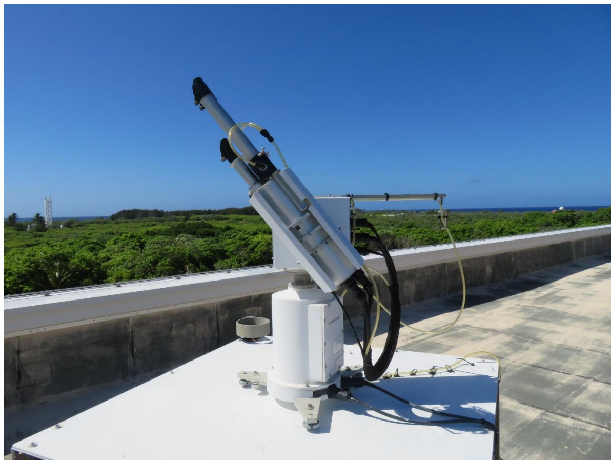
図 7-2-29 南鳥島でのスカイラジオメーター観測（平成16年～） 気象研究所経常研究において、南鳥島気象観測所にスカイラジオメーターを設置し、 分光放射観測によるバックグラウンド観測を開始した。
