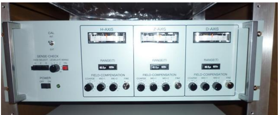
図 7-4-13 フラックスゲート磁力計（1993年～） 検出器（上）と増幅器（下）
