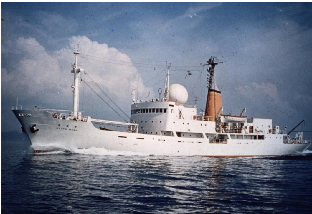
図 5-6-10 凌風丸（Ⅱ世） 昭和41年建造。総トン数 1,599トン。 気象庁の観測船として初めて気象レーダーを備えた。また、凌風丸（Ⅰ世）と同じく離 島の観測所への補給機能を有しており、前甲板には荷役用の設備がある。CTD（電気伝 導度水温水深計）が導入されると、それを用いた海洋観測が可能となるよう改装された。
