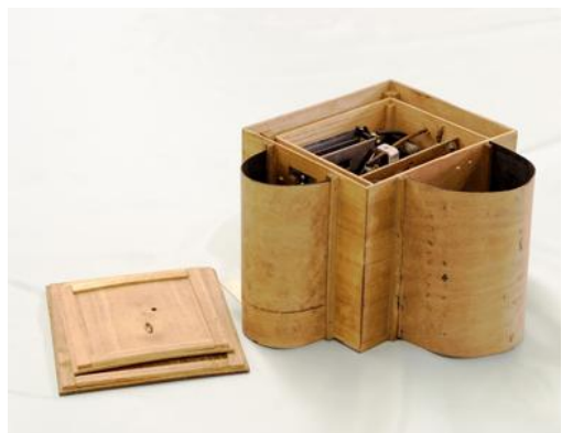
図 5-5-46 中央气象台1号型 ラジオゾンデ
