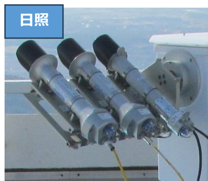
図 5-5-32 直達電気式日射計
