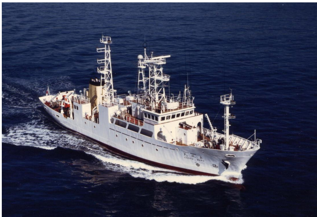
図 5-6-23 長風丸（Ⅱ世） 昭和62年建造。総トン数 480トン。長崎海洋気象台所属新しい世代の中型観測船として、当初からCTD観測や高層気象観測などが効率よく実施できるよう設計・建造された。高風丸（Ⅱ世）、清風丸（Ⅲ世）は準同型船。近年の主な気象庁観測船とは異なり、マストと煙突が一体となったマック形式を採用していないのが外観上の特徴。
