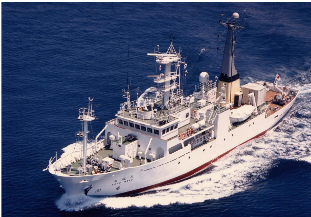
図 5-6-16 高風丸（Ⅱ世） 昭和63年建造。総トン数 487トン。函館海洋气象台所属。 図 5-6-23に示した長風丸（Ⅱ世）の次に建造された同船の姉妹船。新しい世代の中型観測船として、当初からCTD観測や高層気象観測などが効率よく実施できるよう設計・建造された。
