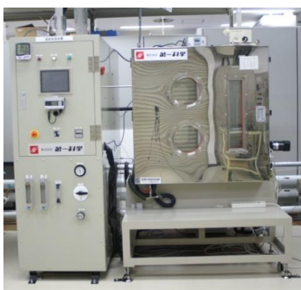
図 5-5-17 湿度計検査装置
