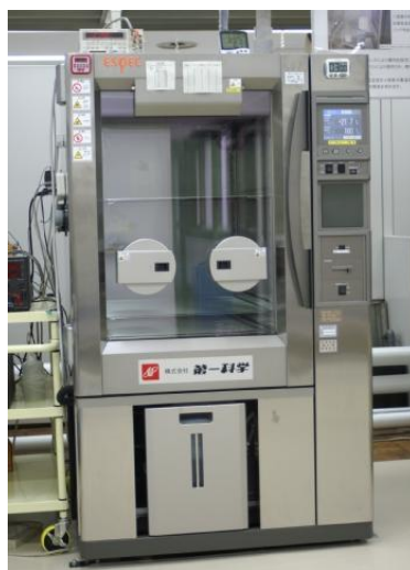
図 5-5-16 温度計検査装置（気槽）
