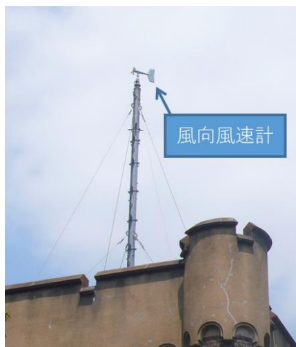
図 5-5-5 大阪市立博物館屋上に 設置した風向風速計
