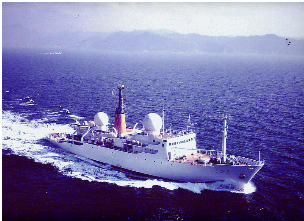
図 5-6-13 啓風丸（Ⅰ世） 昭和44年建造。総トン数 1,795トン。 いわば「洋上の気象台」としての機能を備えて建造され、気象レーダーを搭載している（船橋上のレドーム内）。なお、後部のドーム内には、高層気象観測用の気球追尾用のアンテナが装備されている。凌風丸（Ⅱ世）と同様に、晩年にはCTD観測が可能となるよう改装された。
