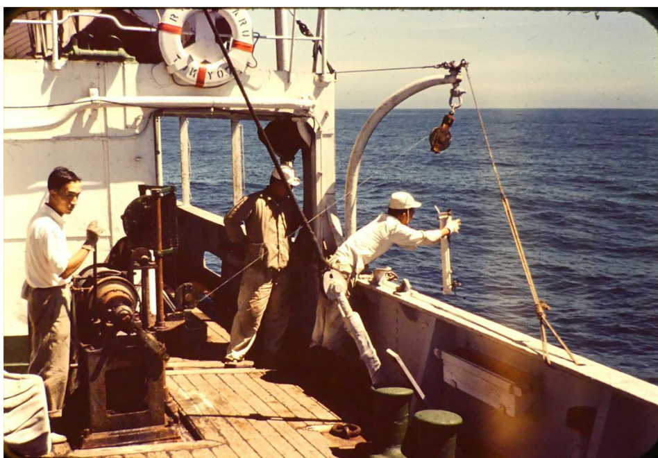
図 5-6-24 凌風丸Ⅰ世による海洋観測風景（1958年） ナンセン式採水器を用いた各層観測を実施中である。画面右端の観測員の手元に見える白い筒状のものが、ナンセン式採水器である。画面左側のウインチから伸ばされたワイヤーに採水器を取り付けているところと思われる。1本の採水器の取り付けが終わると、さらにワイヤーを繰り出し、所定の長さ（≒深度）に達したところで止め、別の採水器を取り付けるという作業を繰り返す。
