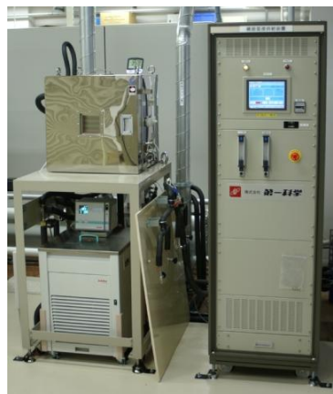
図 5-5-18 恒温恒湿検査装置
