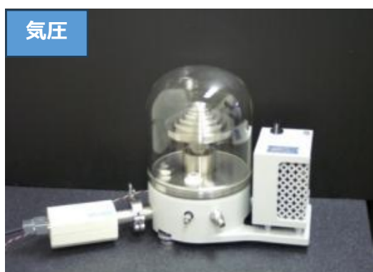
図 5-5-29 ピストン式重錘型圧力標準器
