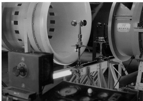
図 5-5-21 風洞測定部と制御関係機器
