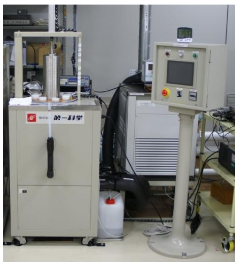
図 5-5-15 温度計検査装置（液槽）
