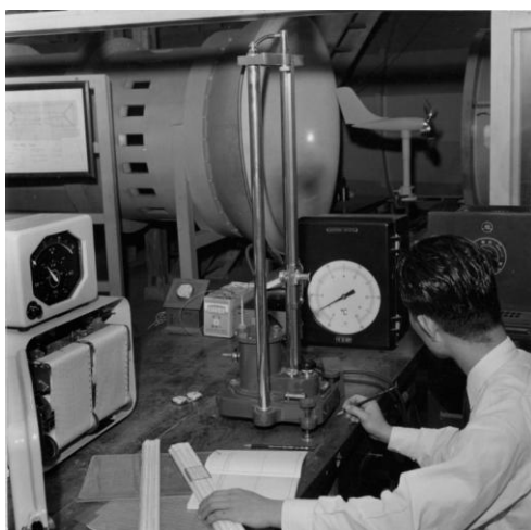
図 5-5-22 風車型風速計の検定風景
