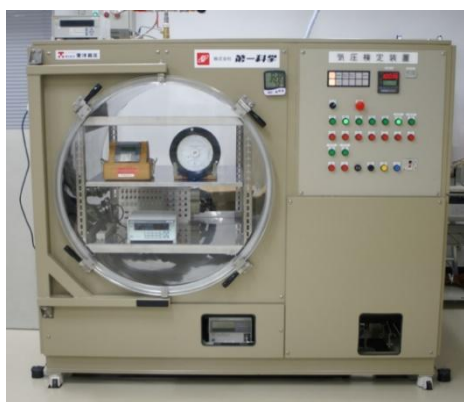
図 5-5-19 気圧検査装置
