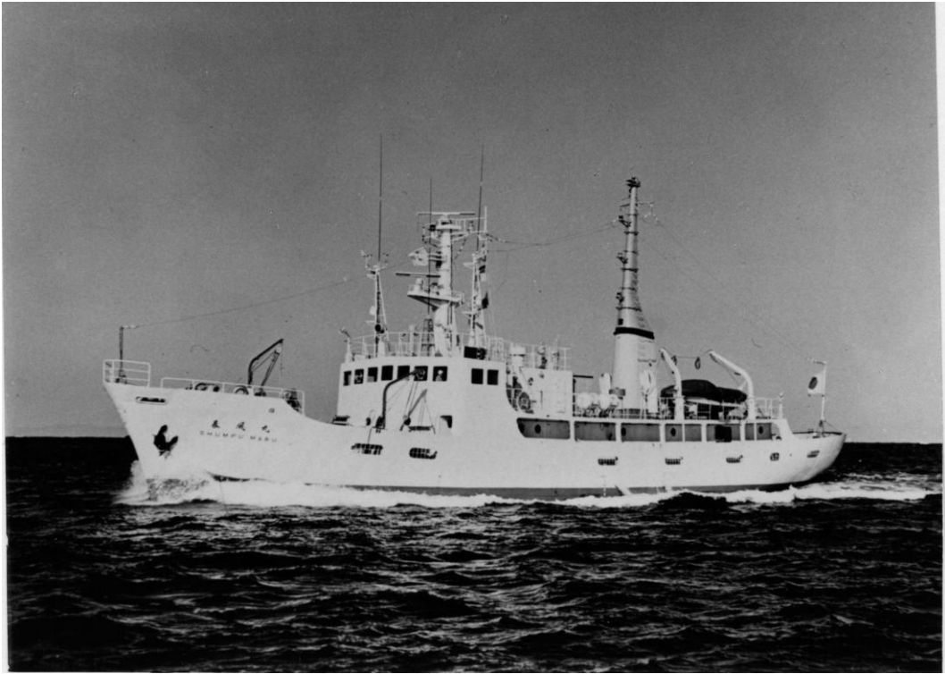
図 5-6-21 春風丸（Ⅲ世） 昭和49年建造。総トン数 373トン。神戸海洋気象台所属。他の海洋気象台に新しい世代の中型観測船（長風丸（Ⅱ世）など）が配備されるのと時を同じくして、CTD観測が可能となるよう改装された。
