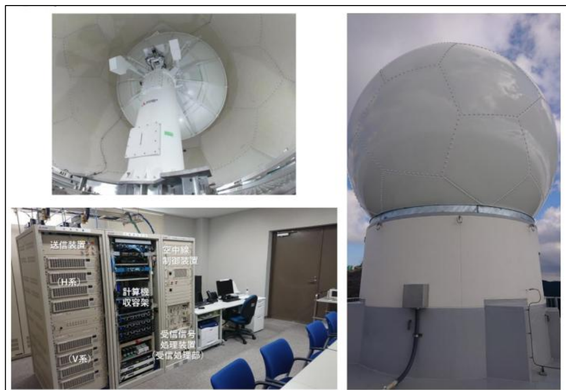
図 5-5-44 二重偏波気象ドップラーレーダー (主要装置の主な外観 三菱電機株式会社製)
