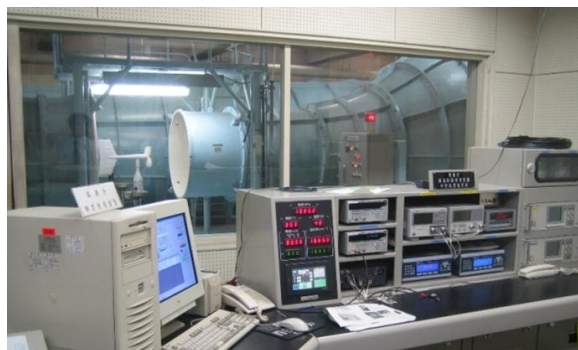
図 5-5-23 風洞測定部と制御卓
