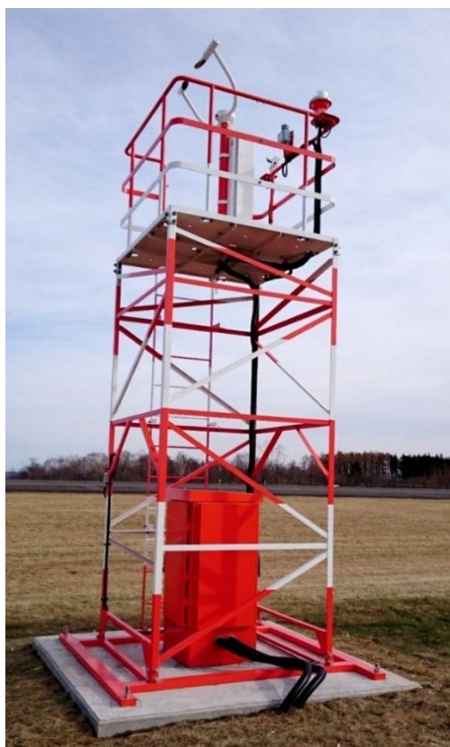
滑走路視距離観測装置（全景）
