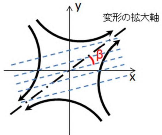
付録第 1.2 図 合流変形による frontogenesis の模式図
