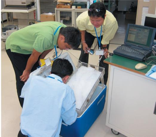
写真1 氷点検査装置を用いて、0℃におけるタイ気象局基準器(ガラス製温度計)の校正を実施するタイ気象局職員
