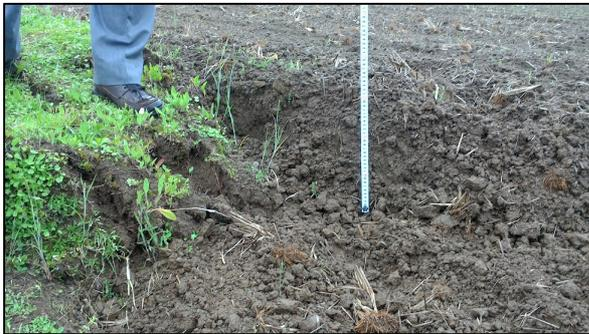
写真8 上下方向の変位量は約 0.3 メートル
