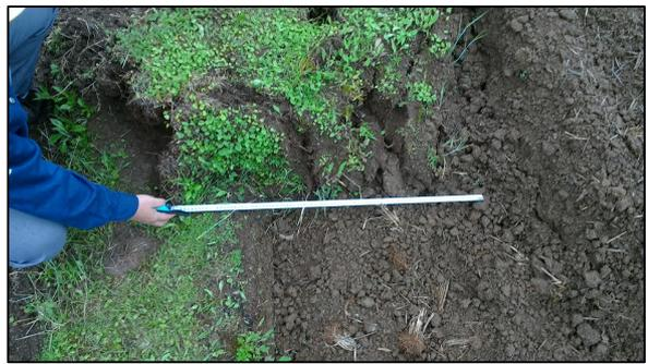
写真9 水平方向の変位量は約 0.6 メートル
