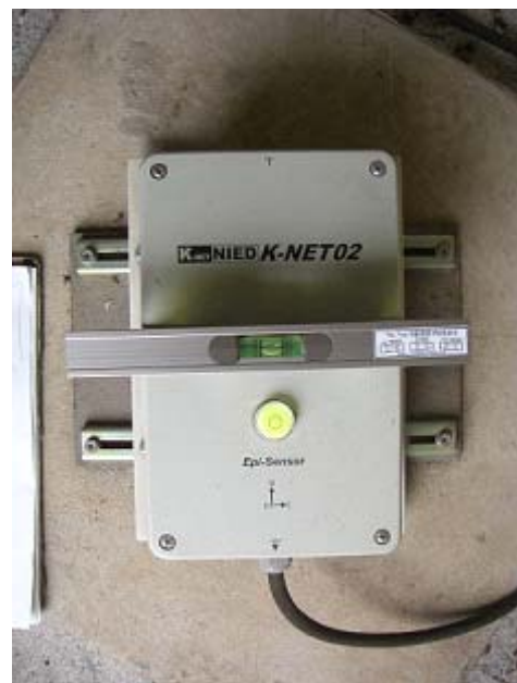
震度計の設置状況
