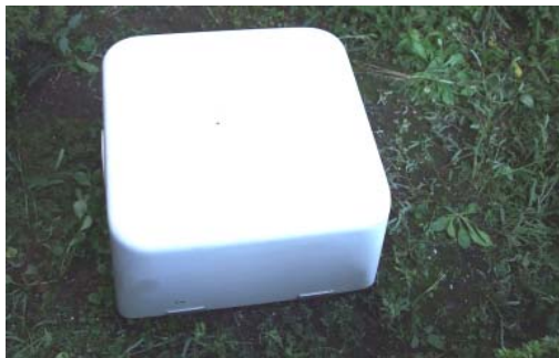
震度計の外観状況
