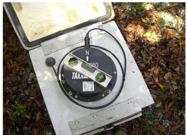
震度計設置の状況
