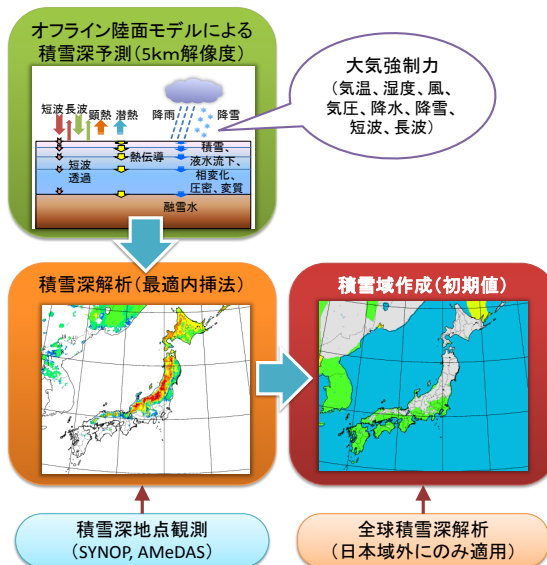
図 2.2.3 現業化した積雪域解析の仕組み。MSM 予測値や観測値から作成した大気強制力を用いてオフライン陸面モデルで積雪深を予測する。予測した積雪深を第一推定値として 2 次元最適内挿法を用いて積雪深の解析値を作成する。日本域については、その解析値から積雪域（積雪あり・なし）を作成する。日本以外の領域は全球積雪深解析値から積雪域を作成する。
