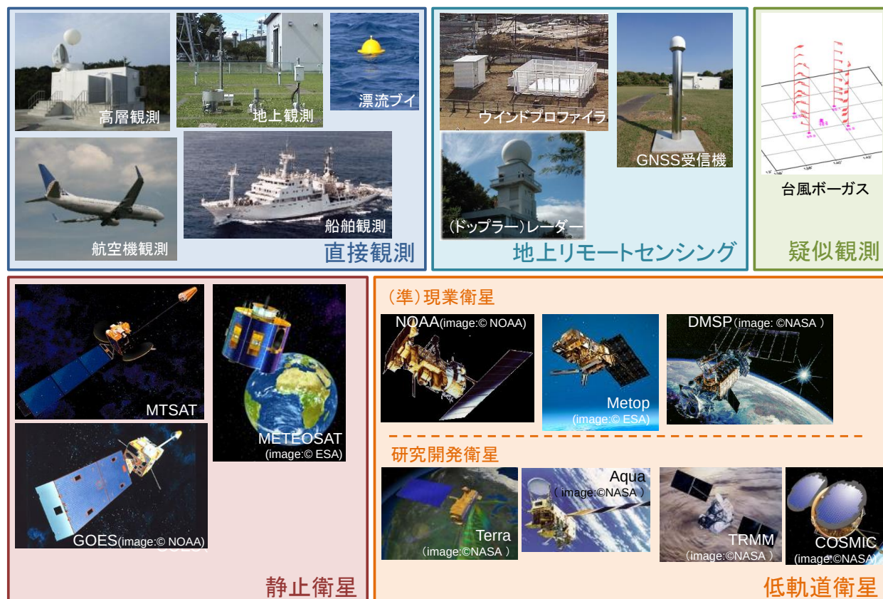
図 2.2.1 気象庁の数値予報の初期値解析で用いられる各種観測測器や測器を搭載する衛星など（2012 年 7 月現在）
