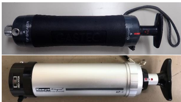
写真7 ガス採取器（収納時の状態） 上：ガステック製（製品名：検知管気体採取器） 下：光明理化学工業製（製品名：真空法ガス採取器）
