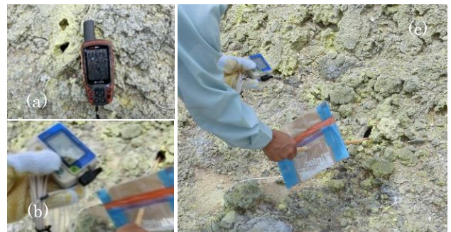
写真 13 噴気孔の位置及び温度の測定場面
