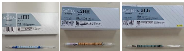
写真8 ガス検知管（本研究で使用した三種類） 左：硫化水素（H 2 S） 規定量 100mL（50mL 吸引時は値を2倍する） 中：二酸化炭素（CO 2 ） 規定量 200mL（100mL 吸引時は値を2倍する） 右：二酸化硫黄（SO 2 ） 規定量 50mL（100mL 吸引時は値を1/2倍する）
