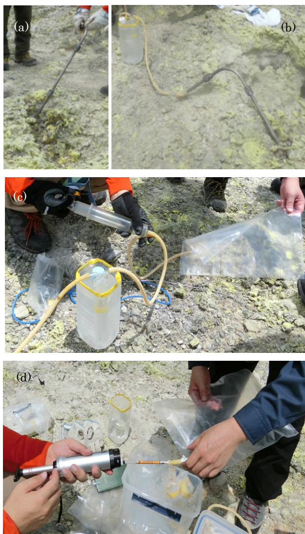
写真2 検知管法による火山ガス成分観測
