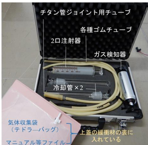
写真 12 火山ガス成分観測の機材収納例
