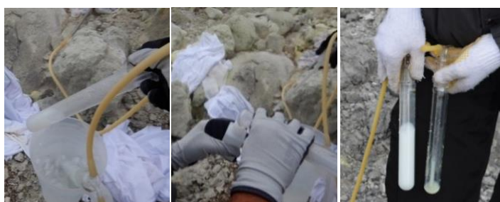
写真 18 火山ガス採取後の凝縮水と取扱い
