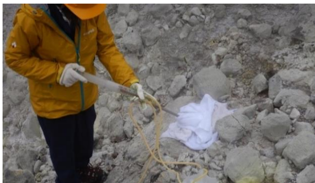
写真 15 吸引器を利用した噴気孔の吸引の様子 ※吸引器を扱う場合はピストン（押込棒）の落下を防ぐため大きく下方へ傾けない。
