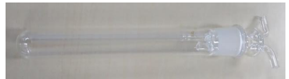
写真 4-b 冷却管 (二口ガラス冷却管) 一般的には入口 (注入) 側には長い方を、出口 (排出) 側には短い方のガラス管を適用する。
