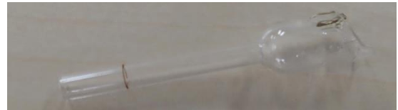
写真 4-c 径変更用ガラス管 既製品を加工利用 : Φ12 から Φ5 に変形
