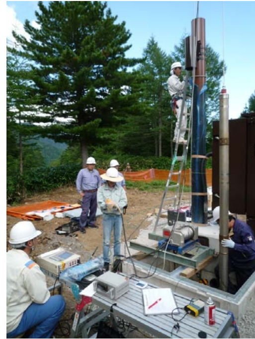
地震計・傾斜計の埋設時の様子（乗鞍岳・三本滝）
