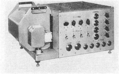
第39図 59型光学式電磁地震計記録器
