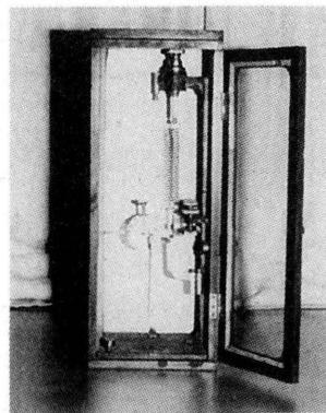
第3図 仙台の上下動 (ユーイング振り子) を用いた感震器
