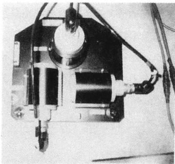
第53図 軽井沢測候所の観測点に設置した米国マークプロダクト社の固有周期1秒のLAC変換器。
