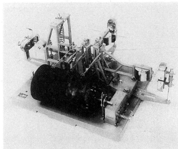
第30図 52B型機械式1倍強震計
