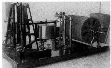
第17図 松本測候所の中央気象台式簡単微動計
