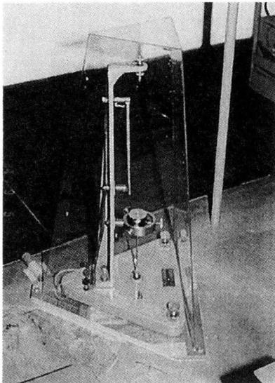
第4図 気象測器工場で製作され河口湖測候所に配分された51型感震器
