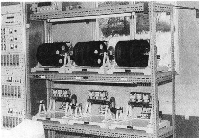
第57図 軽井沢測候所のA74型火山性震動観測装置の受信記録装置、3観測点3成分の信号が上下2段の記録ドラムに12時間切り替えて交互に連続記録される。
