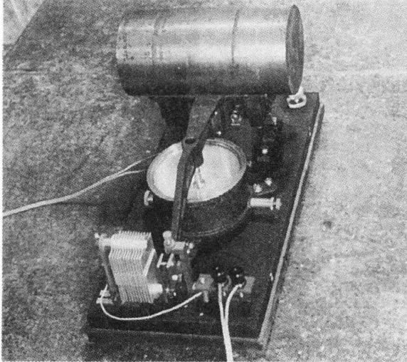
第38図 可変容量型電磁地震計変換器
