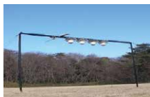
地表からの反射日射量、及び 上向き赤外放射量の観測
