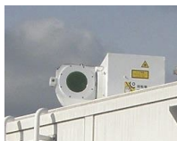
スキャナ部 散乱光の一部を スキャナで受ける
