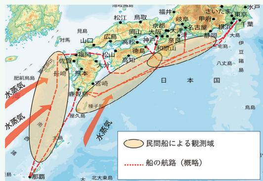
赤破線は定期船の航路を表し、楕円は GNSS 観測装置の設置により観測が可能となる海域を表します。
