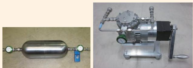
(上) 気象庁職員が航空機内において手動でポンプを回し、機外の大気を採取します。(下) 大気採取に使用する容器と手動ポンプ。
