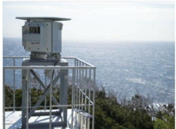
沿岸の数十メートルの高台に設置した観測装置から数百メートル先の海面に電波を照射し、反射して戻った電波が変化している様子から波の高さ、周期及び波向きを観測します。
