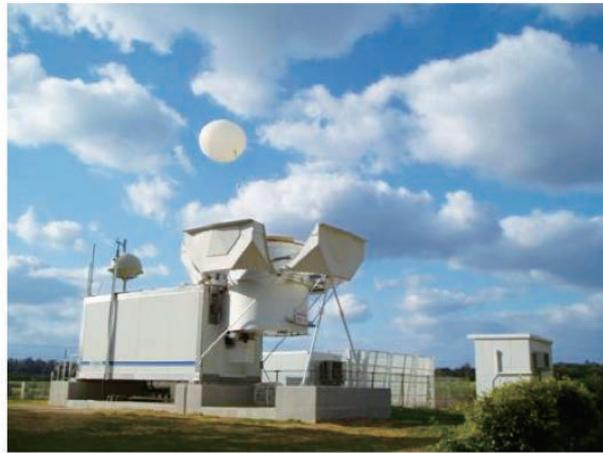
人の手で行うラジオゾンテ飛揚(左)と機械で自動的に行うラジオゾンテ飛揚(上)
