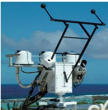
直達日射は、太陽を自動的に追尾して観測しています。また、散乱日射や赤外放射は、黒い遮蔽球により直達日射を常に遮って観測しています。
