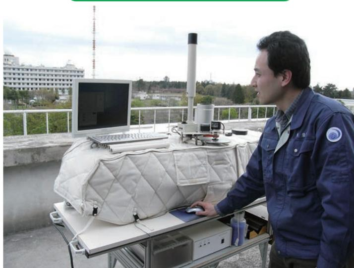
(右写真) ドブソンオゾン分光光度計を操作して、オゾン全量を観測している様子。この観測を1日に3～5回行っています。
