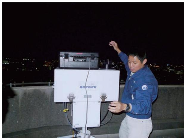
測器の状態を点検している様子です。太陽が出ている日中は観測を行っていることから、観測をしていない夜間に点検を行います。紫外線を細かく正確に測定するためには、定期点検が欠かせません。
