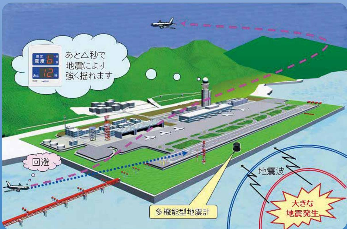
主要な13空港では、管制機関に対し、その空港における緊急地震速報や震度情報を提供しています。このうち、緊急地震速報については、航空機の運航に影響を及ぼすおそれがある場合、管制官から空港に離着陸する航空機に対し、情報提供されます。
