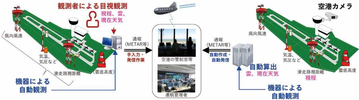
風などの自動観測に加え、目視により観測している要素を滑走路付近に設置している各機器を利用して自動で観測し、離着陸に重要な滑走路上の気象状況及びその変化をリアルタイムかつ的確に利用者に提供しています。完全自動化は関係機関と調整のうえ、準備が整った空港から順次導入しています。
