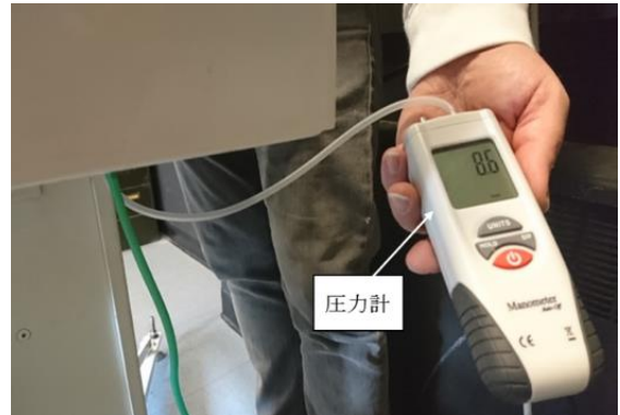
付録写真3 測器内部の空気漏れチェック
