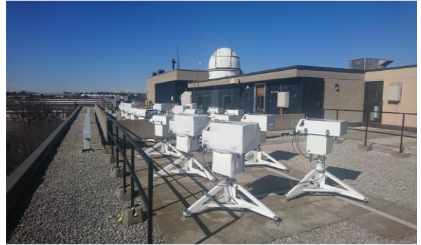
写真1 ECCCにおけるWMOブリュワー分光光度計の国際比較2018の様子(庁舎屋上)。設定した比較観測のスケジュールが自動で実施される。右手前が気象庁の測器BR#113, その奥隣りが同じくBR#174である。
