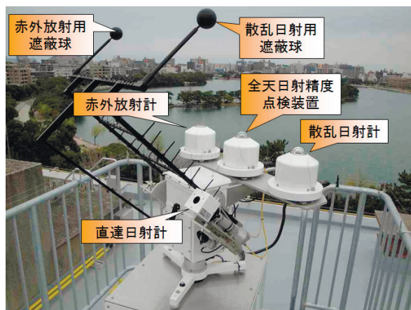
第2図 福岡管区気象台設置の精密日射放射観測装置感部
