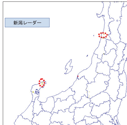
第 1.2.5.3 図 新潟レーダーにおけるクラッタマップ適用の例
