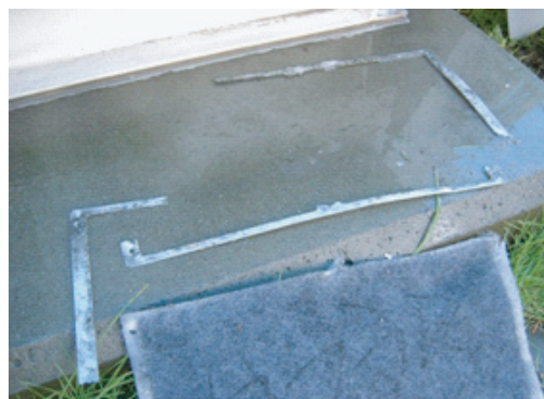
第2.6図 勝浦観測局モジュール収容架空気取入口の状況 （左：外枠に付着した白い腐食物、右：腐食により崩れてしまったフィルター押さえ枠）
