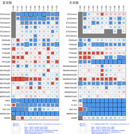
図 2.3.41 夏期間(左)、冬期間(右)の検証スコア・RMSE の変化有意性の統計検証結果。各行は統計検証要素、各列は予測時間に対応する。各統計検証要素は、ETS: 降水量のエクイタブルスコア(括弧内は降水量の閾値)、Z: ジオポテンシャル高度、MIXING(QV): 混合比、T: 気温、WIND: 風速、PSEA: 海面更正気圧、DSWB: 地上における下向き短波放射をそれぞれ表す。青がCNTLと比べて改善、赤がCNTLと比べて改悪を表しており、色付きの領域が各セルの内側の正方形以上の場合、95パーセント信頼区間で統計的に有意であることを示す。
