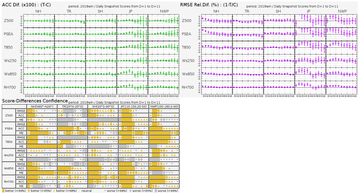
図 2.2.24 冬期間における対流圏主要要素の解析値に対する ACC の改善幅 (左上図)、RMSE の改善率 (右上図) と TEST と CNTL のスコア差の有意性判定 (左下図: スコアカード)。解析値を参照値としている。検証対象の領域は、NH が北半球 (20°N 以北)、TR が熱帯 (20°S - 20°N)、SH が南半球 (20°S 以南)、JP が日本周辺 (110°E-150°E, 20°N-50°N)、NWP が北西太平洋領域 (100°E-180°E, 0°-60°N) を意味する。要素は上から 500 hPa 高度、海面更正気圧 (PSEA)、850 hPa 気温 (T850)、250 hPa 風速 (Ws250)、850 hPa 風速 (Ws850)、700 hPa 相対湿度 (RH700)。スコアカードはそれぞれ上から RMSE、ACC、ME、黄色、灰色がそれぞれ統計的に有意に改善、悪化していることを示しており、塗りつぶし面積が広いほど統計的有意性が高い。
