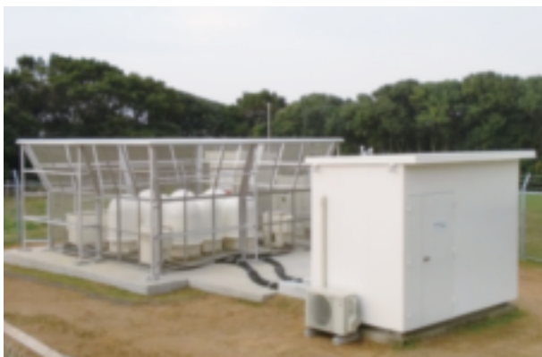
ウィンドプロファイラ観測局（清水）の全景。フェンス内に11個のアンテナが設置されています。
