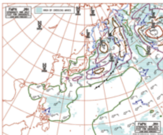
(左) 外洋波浪予想図：波高が1.8m以上で、二つ以上の波が存在して海面が複雑になる海域を横ハッチでマーク、それぞれの波情報も表示。 (右) 沿岸波浪予想図：波高が1.0m以上で、波と逆向きの海流により波高が増大し、海面の変化が激しくなる海域を縦ハッチでマーク。
