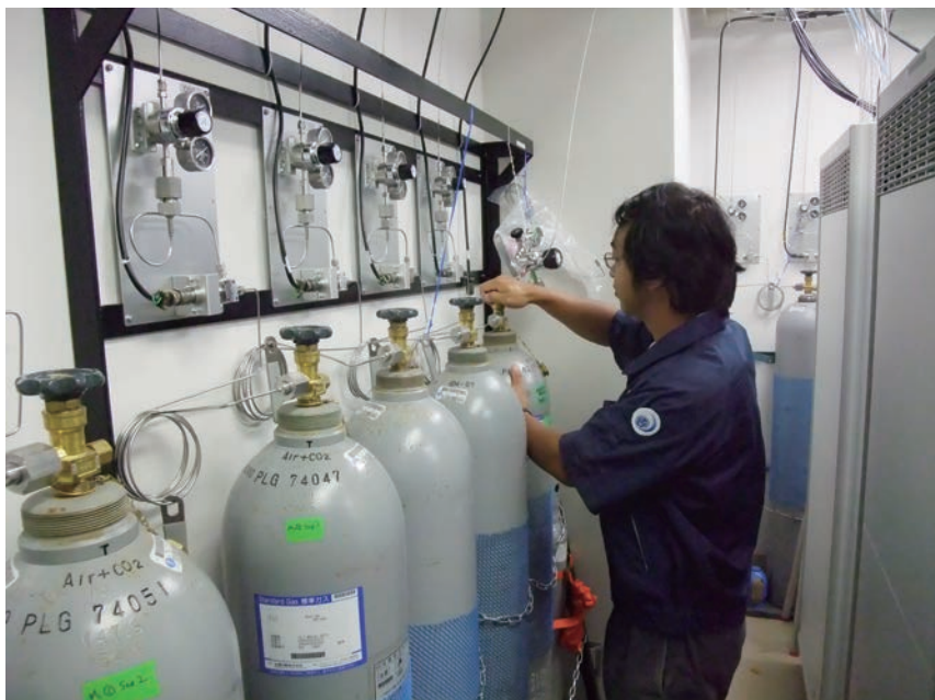
温室効果ガスの観測では、精密に測定された標準ガスの濃度を基準として、大気中の濃度を決定しています（写真は、標準ガスを充填してあるボンベの状態をチェックしているところ）。
