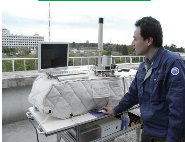
(右写真) ドブソンオゾン分光光度計を操作して、オゾン全量を観測している様子。この観測を1日に3～5回行っています。
