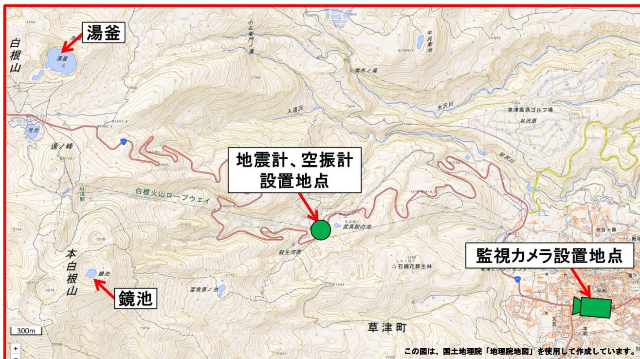
臨時で設置した火山観測機器の配置図
