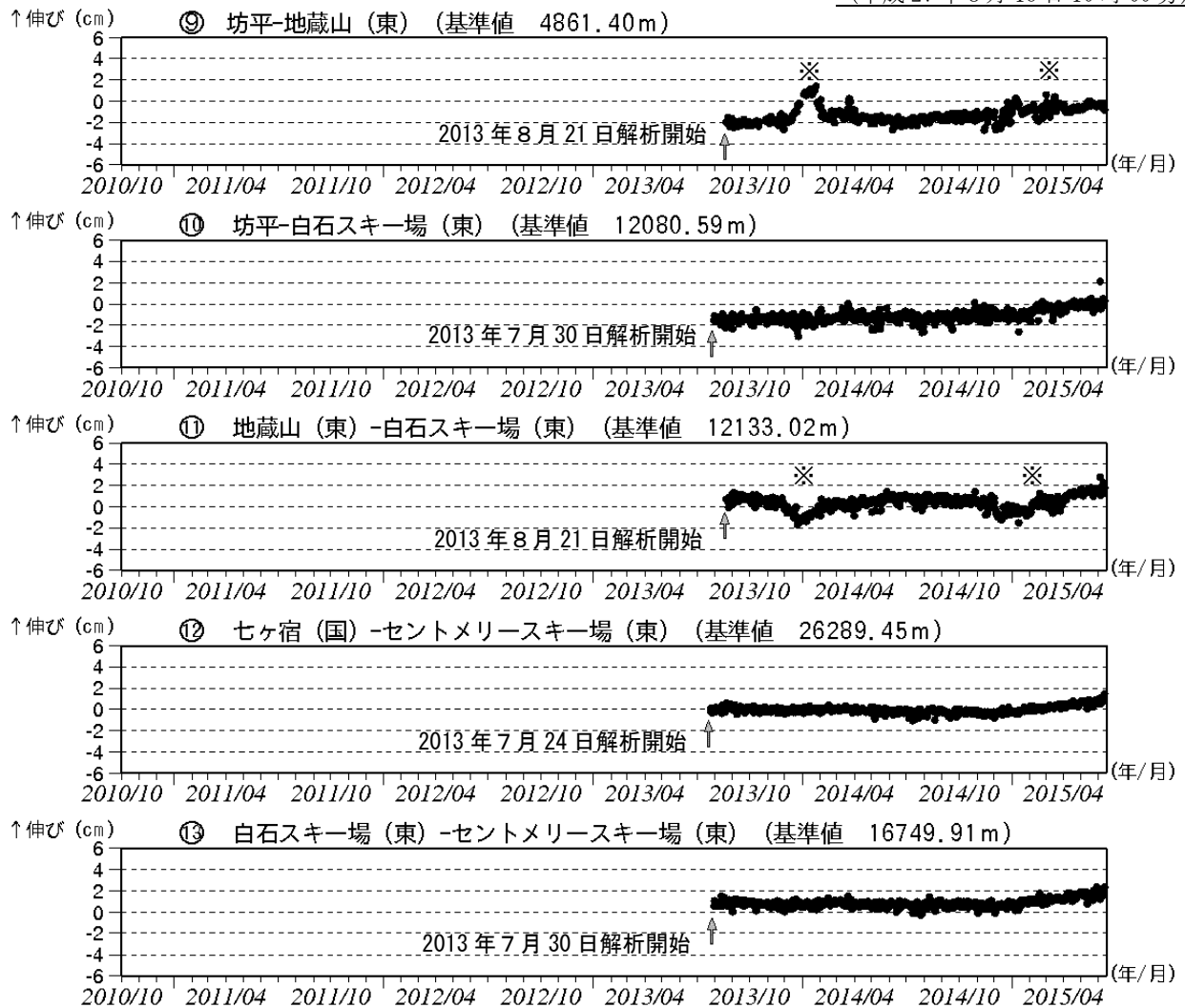
図 9-② 蔵王山 GNSS 基線長変化図 (2010 年 10 月～2015 年 6 月 15 日)
