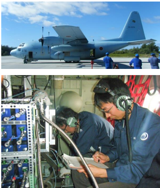
図F 観測に使用する自衛隊輸送機（上）、航空機内での大気試料の採取作業（下）
