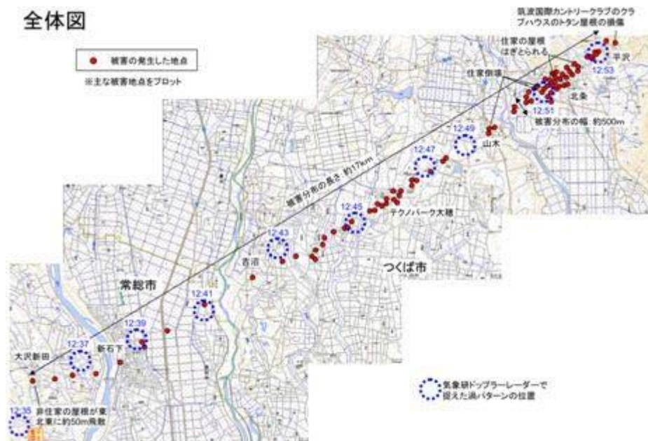
第 10 図 気象研究所・水戸地方気象台・銚子地方気象台による現地調査で判明した突風被害の分布（赤プロット）、及び気象研究所固体素子二重偏波ドップラーレーダーで捉えられた上空の渦（青丸）。
