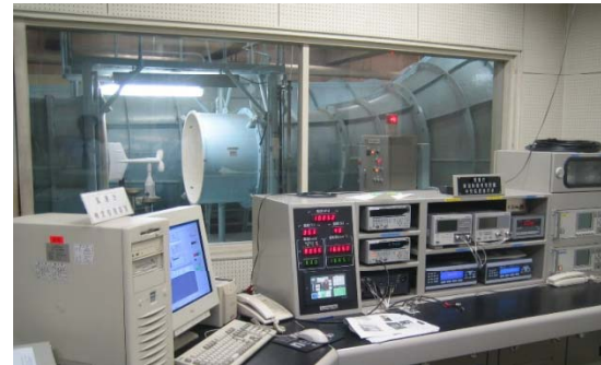
風洞(2代目) 気象庁庁舎内(大手町) 使用年:1964~2012 鋼製風洞 検査範囲:0.35m/s~90m/s
