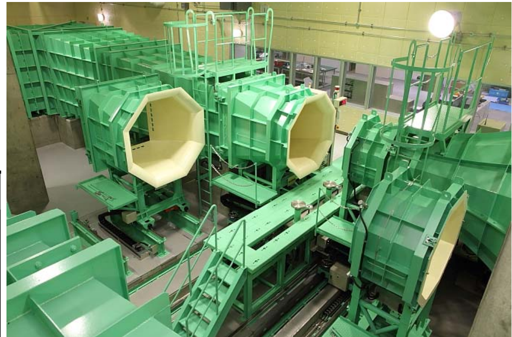
風洞(3代目) 高層气象台敷地内(つくば) 使用年:2012~ 鋼製風洞 検査範囲:0.35m/s~108m/s
