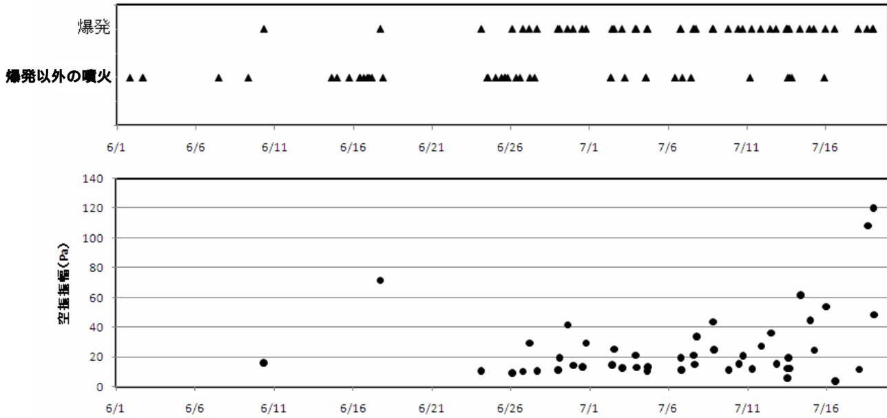
図 1 桜島 最近の昭和火口の噴火及び爆発的噴火の発生状況（上段）及び爆発的噴火に伴う空振振幅の経過（下段）(2009年6月1日から7月19日09時)
