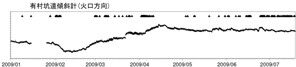
図 4 桜島 有村観測坑道の水管傾斜計 (大隅河川国道事務所設置) の変化 (2009 年 1 月 ~ 7 月)
