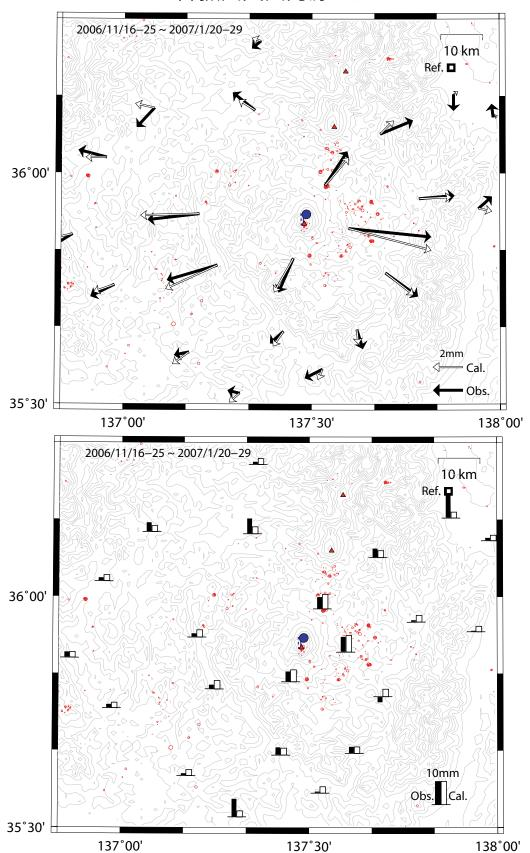
力源モデル (球状圧力源(丸の領域)+開口断層(矩形領域))6の最適パラメータ 球状圧力源: N35.911 E137.485 Depth 10.0km ΔV 3.7×10 m<sup>3</sup> 開口断層: N35.913 E137.478 Depth 5.4km Length 2.7km Width 5.0km Strike 179 Dip 83 Open 0.33m [ΔV 4.5×10 m<sup>3</sup>]
