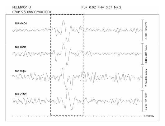
図 4. MK01 と TKN 1、YKE2、KYM2 に設置された広帯域地震計の上下動成分について 14 秒~50 秒の バンドパスフィルターをかけた速度波形. 破線の囲みは火山性微動波形に対応する時刻. 周期 15 秒から 20 秒の超長周期イベントが検出されている.
