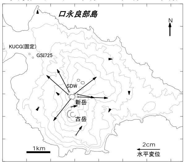
2006年1月から12月(山頂部は2007年2月)までのGPS繰返し観測による変位を示す.新岳火口を中心とする放射状の変位ベクトルが得られた.変位量は最大で2.5cm.火口から0.5km以上離れた山麓では変位が検出できなかった.圧力源の深さは100-200m程度と推定される.
