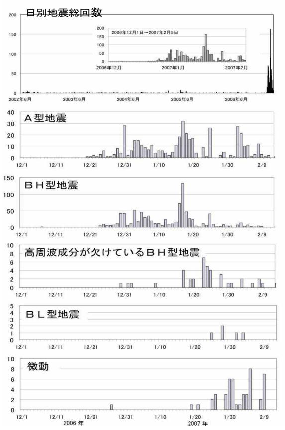
図10 御嶽山 火山性地震・微動の波形タイプ別の発生回数の推移
