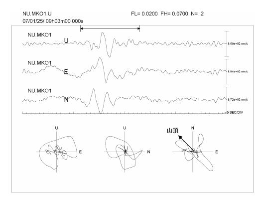
図 5. 名大牧尾観測点 (MKO 1:山頂から 14km) における振動軌跡. 振動軌跡は山頂方向を示す.
