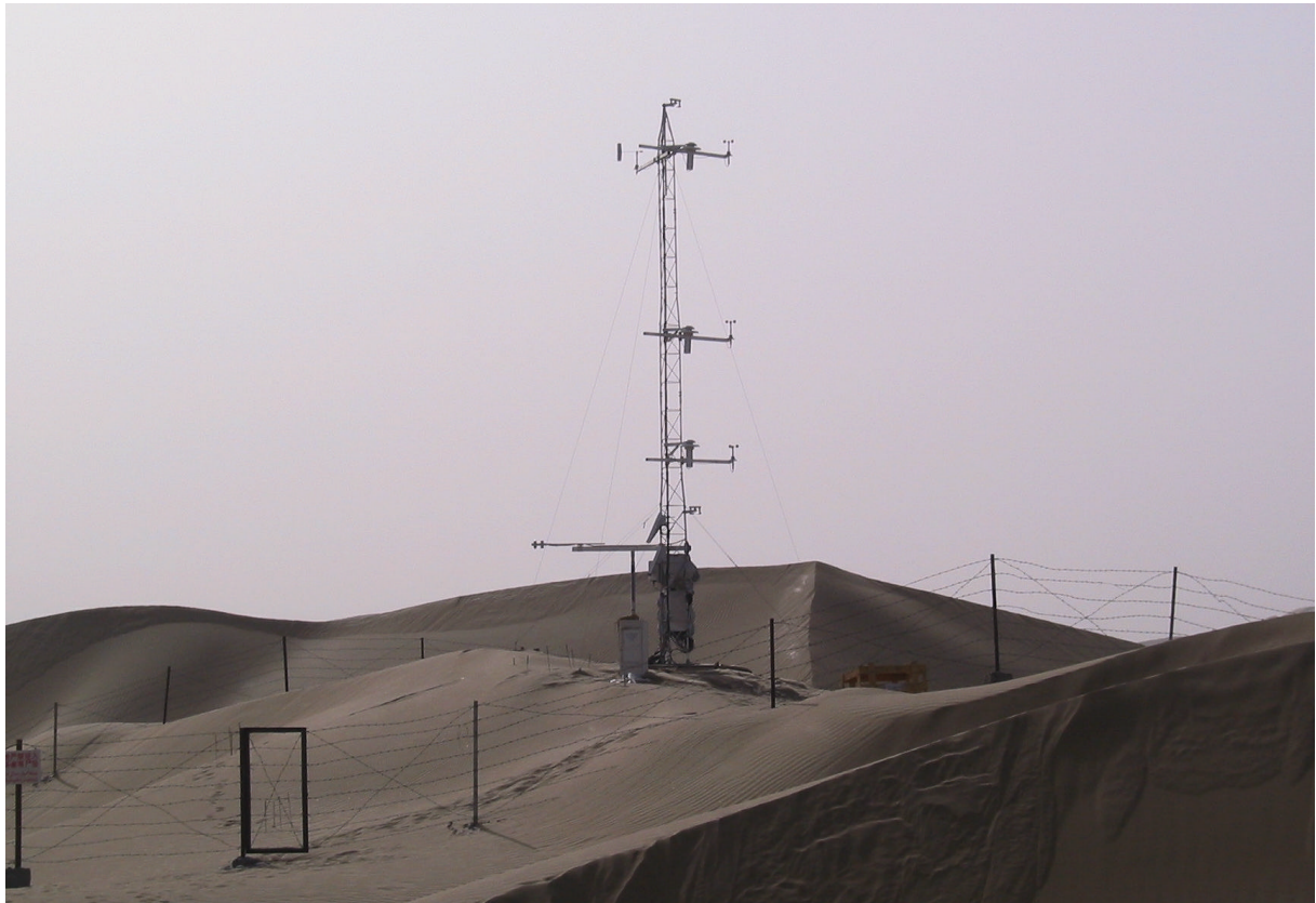
写真3 タクラマカン砂漠南部の砂砂漠上に設置された自動気象ステーション。中国国内の砂漠7カ所に同様の観測機器が設置され、ダスト粒子の舞上りを観測した。
