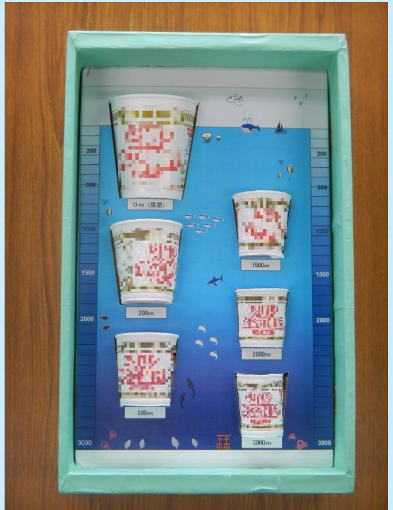
水圧で縮んだカップ麺の容器(容器の下の値は水深に対応)
