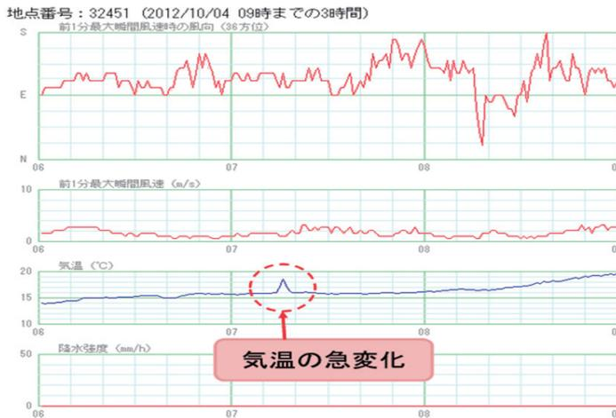
第9図 航空機のブラストによる気温の急速変化の事例
