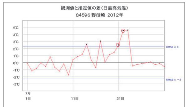
第19図 通風筒ファン停止による気温の緩慢変化の事例
